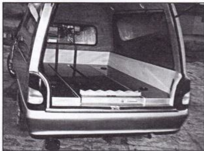
Wnętrze samochodu pogrzebowego Polonez z podłogą pokrytą w całości blachą nierdzewną. Na boku widoczna płyta zasłonowa z wygodnym, nie wymagającym wchodzenia do środka, zatrzaskiem.
