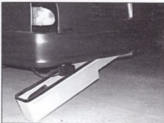
Pojemnik na narzędzia jest schowany w tylnej części nadwozia, a w wypadku potrzeby opuszczany na rolkach na ziemię.
